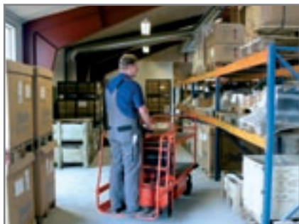
Για μικρού μεγέθους αγαθά μπορεί να τοποθετηθεί μια μικρή πλατφόρμα.
